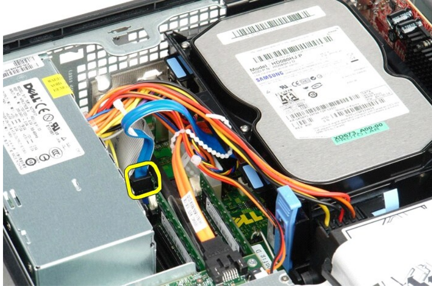
4. לחץ על לשוניות הבטחה הכוחות שמשיני צידי מכלול הכונן הקשיח ולאחר מכן החלק את המכלול כלפי מעלה אל מחוץ למחשב.
